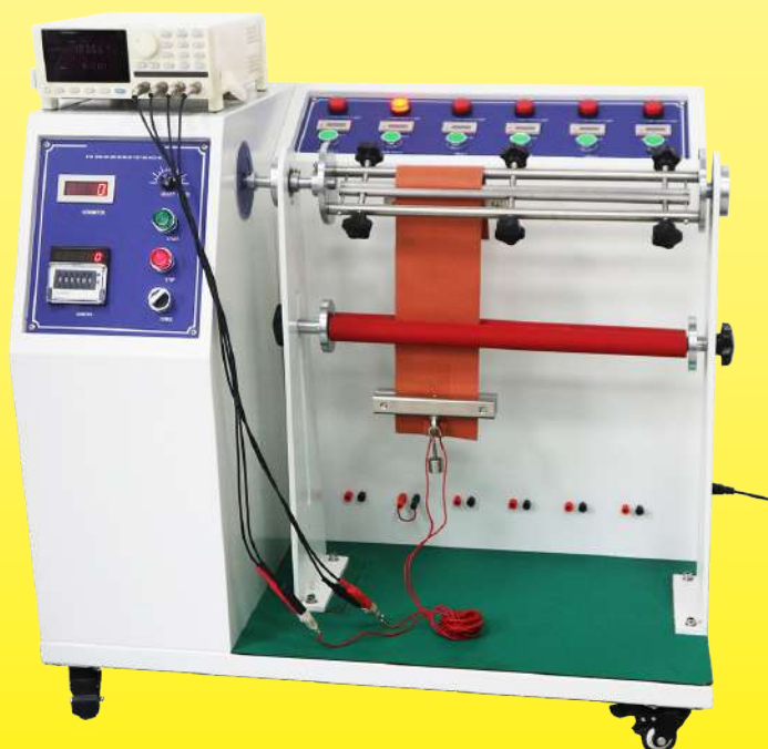
Гибкий силиконовый нагреватель при проведении испытания на сгибание
